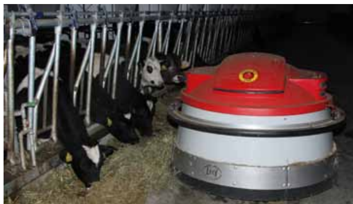
Robot samodejno dozira seno ali drugo hrano govedu po programu takorekoč nonstop.
